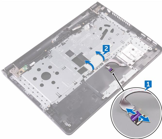
**3** 撕下將觸控墊板固定於手掌墊組件上的膠帶。
