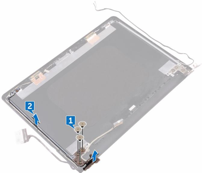
**3** 記下顯示器纜線的佈線，並將顯示器纜線從顯示器背蓋和天線組件上的固定導軌移除。
