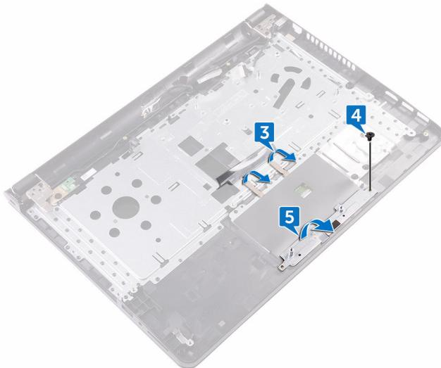
**6** 卸下將觸控墊板固定至手掌墊組件的六顆螺絲 (M2x3)。
